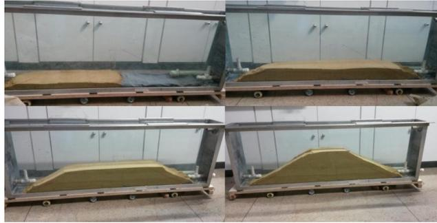
**Figura 10 - Seção da barragem em etapas da construção e compactação.**
