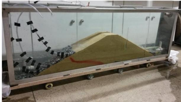
**Figura 91 - Seção da barragem com percolação.**
